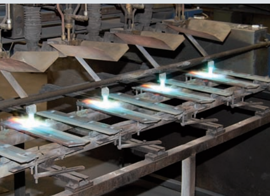
Die Beschichtung kann auf das Werkzeug gespritzt werden oder Pulvermetall wird in einer hochenergetischen Flamme auf die Oberfläche des Metalls geschossen und bildet dort eine Schicht mit hoher Festigkeit.
