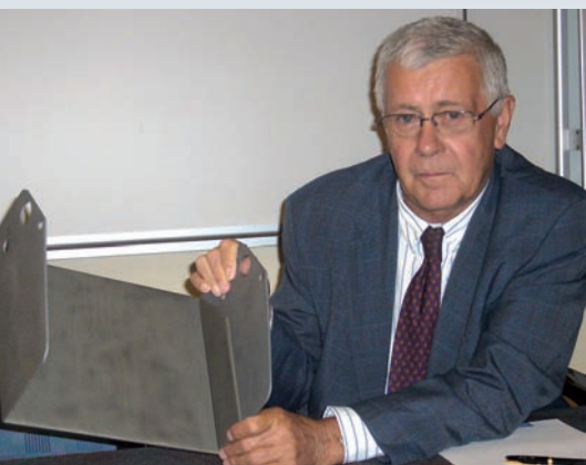
Alois Knöll, Technischer Leiter bei Busatis zeigt hier die beschichtete Auswurfklappe vom Häcksler. Busatis beschichtet bereits für einen Hersteller den Gutflusskanal vom Häcksler, den Boden beim Gebläse beispielsweise bis zur Auswurfklappe ist beschichtet mit 2 mm Schichtstärke.
