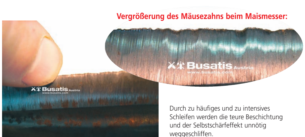
Abb. 3: Das Grundmaterial verschleißt schneller als die Beschichtung an der Schneidkante.
